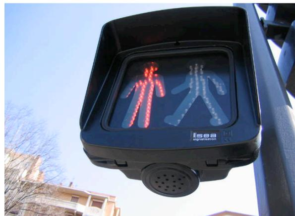
fig.14 système de diffusion des signaux sonores
