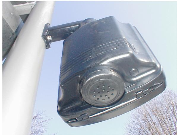
fig.13 système de diffusion des signaux sonores
