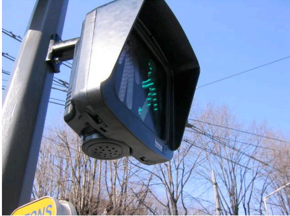
fig.1 système de diffusion des signaux sonores
